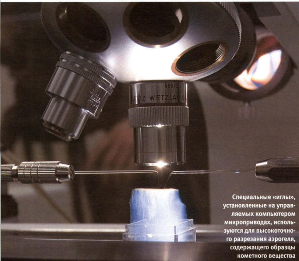
Специальные «иглы», установленные на управляемых компьютером микроприводах, используются для высокоточного разрезания аэрогеля, содержащего образцы кометного вещества
