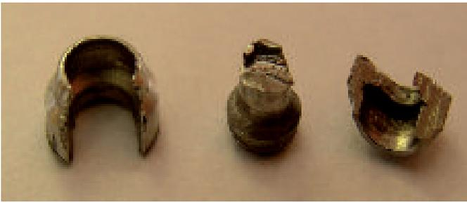
**рисунок 3.** Примеры пластической деформации и разрушения стопорной шайбы и шейки штока
