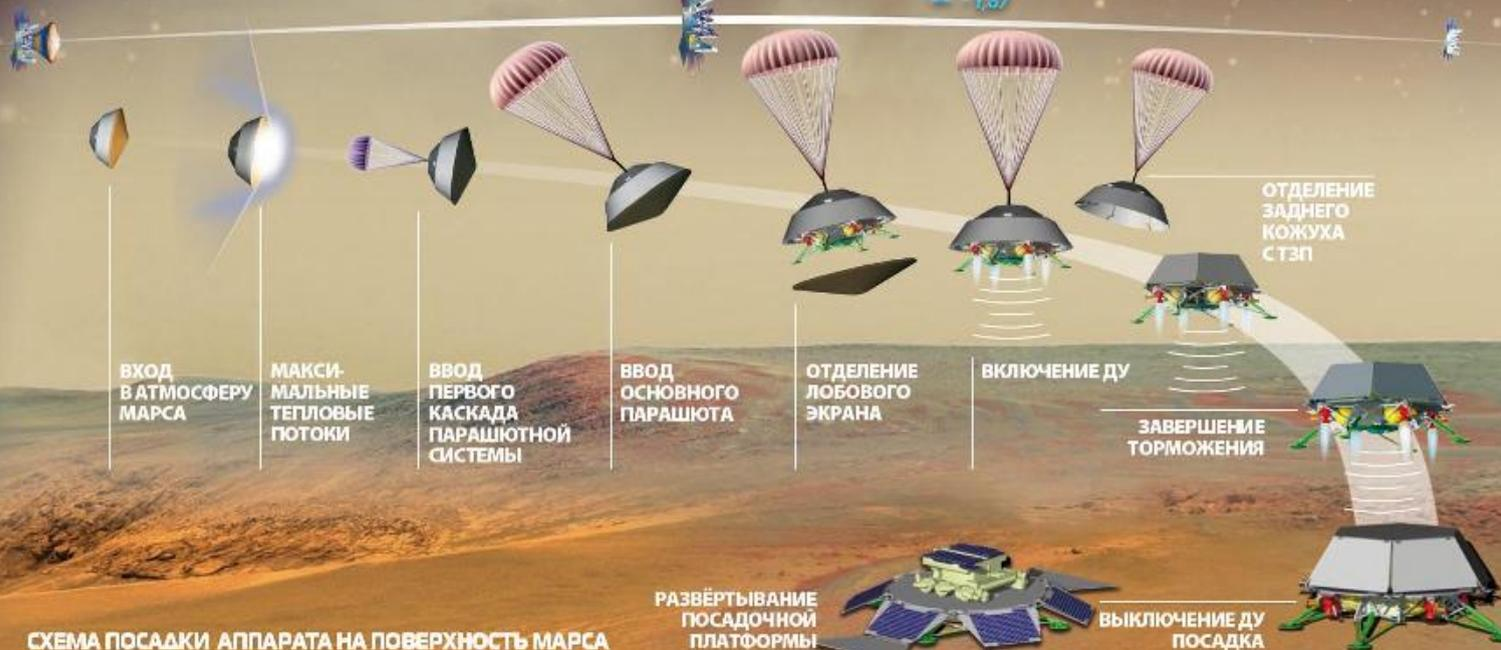
СХЕМА ПОСАДКИ АППАРАТА НА ПОВЕРХНОСТЬ МАРСА
