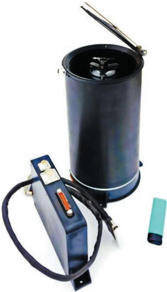
**рисунок 2.** Внешний вид прототипа высокочастотного звёздного датчика
