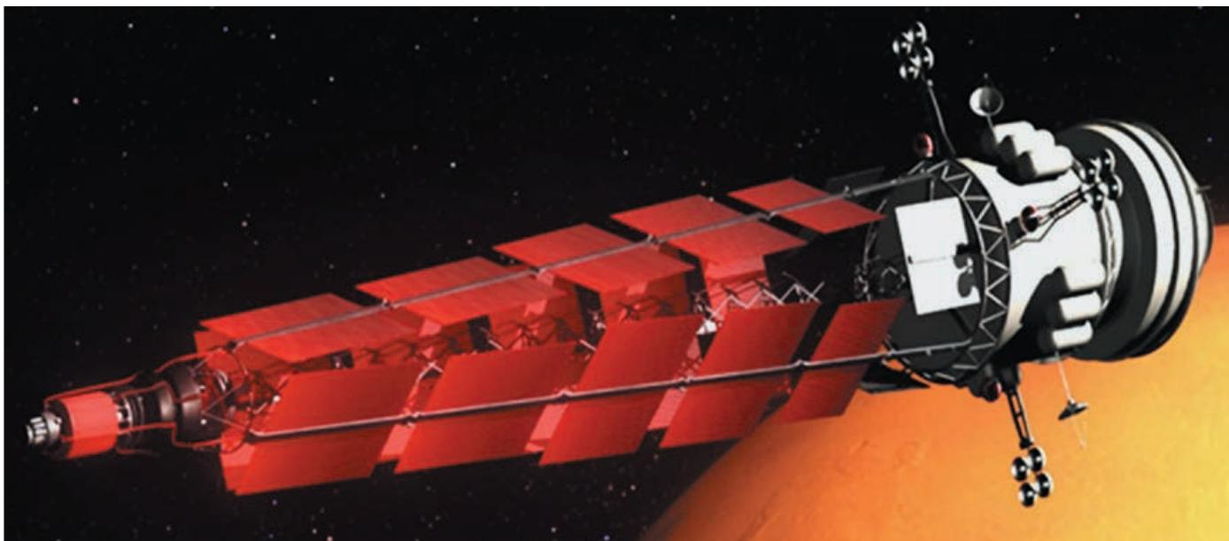
рисунк 1. Общий вид проекта транспортного энергетического модуля с ядерной энергетической установкой
