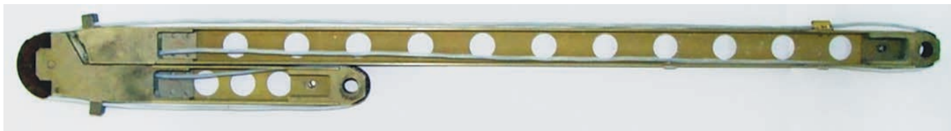
рисунок 2. Рычажное устройство фермы «Рапана»
