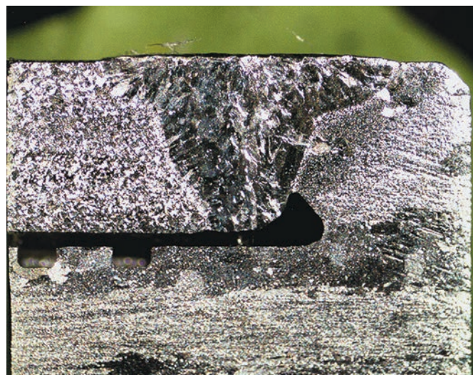
рисунок 4. Увеличенная в 10 раз макроструктура сварного шва тепловой трубы
