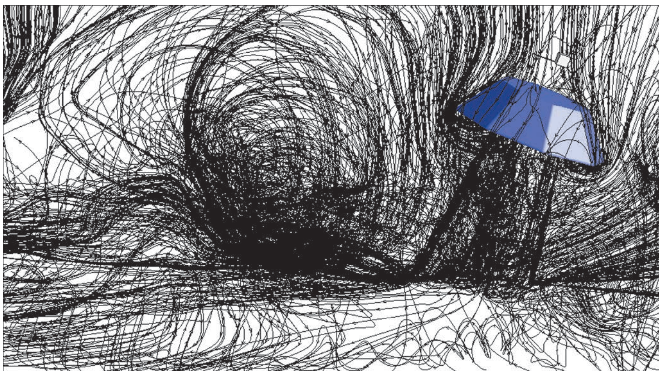
рисунок 2. Изоповерхности плотности газов ТДУ (а) и мгновенные линии тока (б) в момент времени t=20 (0.142 с)
