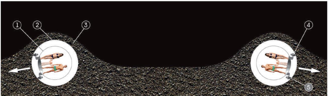
Расчет мощности, необходимой для компенсации аэродинамического сопротивления при давлении 0,1 бар и температуре воздуха  $-30\text{ }^{\circ}\text{C}$ , дает следующие результаты: 1 модуль — мощность 11,2 кВт; поезд из 3 модулей — 22,4 кВт; поезд из 6 модулей — 38 кВт. Требуется также дополнительная мощность для преодоления иных видов сопротивления движению. Модуль с ЭДП — 9 кВт. Модули на пневматических колесах — 31 кВт. Модули на металлических колесах,
