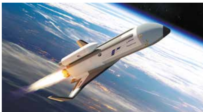
Рис. 10. Многоразовое средство выведения малых КА на низкую околоземную орбиту Phantom Express
