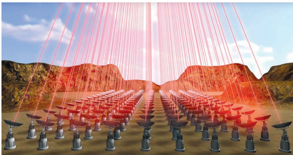
Лазерная силовая установка с фазированной решеткой для передачи лазерного луча на парус зонда (с официального сайта проекта "Breakthrough Starshot": https://breakthroughinitiatives.org/page/14 )
