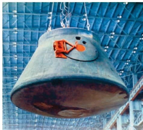
Теплозащита отсека экипажа ВА
